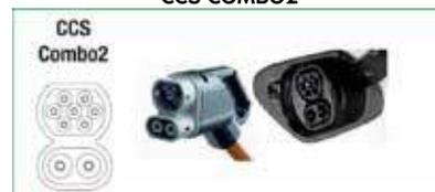
Lo standard **CCS (Combined Charging System)** consiste in un unico connettore di ricarica sul veicolo elettrico, che consente sia la **ricarica rapida in corrente continua (DC)** sia la **ricarica lenta in corrente alternata (AC)**.
